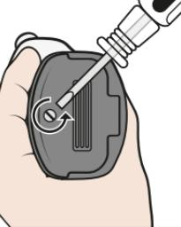
Åpne batteridekselet med skrutrekkeren.
