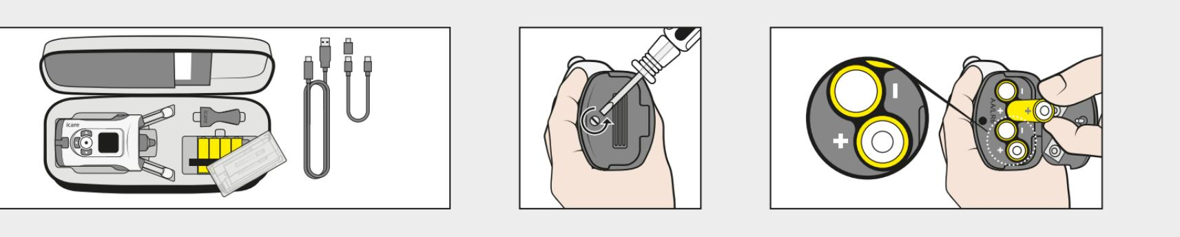
Paristot ovat silmänpainemittarin kantokotelossa anturirasiin alla.
